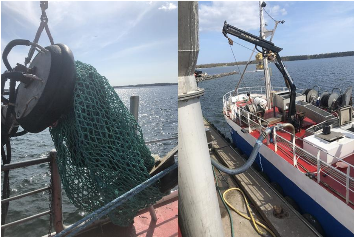
Figur 6. T.v. visas munstycke för anslutning till trål och t.h. visas pumpning från fiskebåt till vattenavskiljare.
