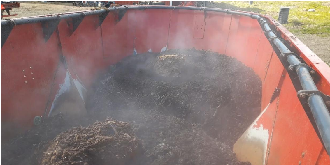
Figur 13. Testförsök att hygienisera restströmmar av musslor genom kompostering med ensilage och hönsbajs.
